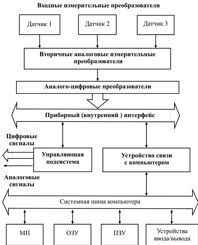
**Рис. 16.3.** Структурная схема измерительно-вычислительного комплекса
